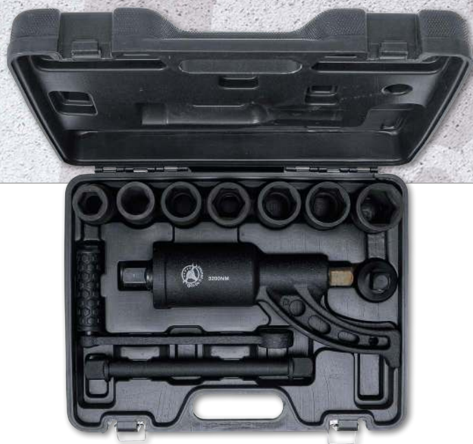
Drehmoment-Vervielfältiger-Satz | Antrieb Innenvierkant 25 mm (1") | 3200 Nm
