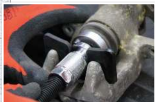
Bremskolben-Rückstell- Werkzeug | universal | 0 - 66 mm
