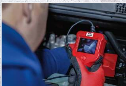
Endoskop-Farbkamera mit TFT-Monitor | Kamerakopf Ø 5,5 mm
